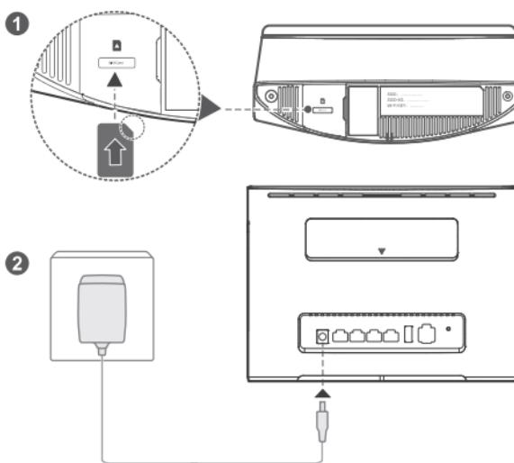
Inserte una tarjeta micro-SIM en la ranura correspondiente, como se muestra en el diagrama anterior. A continuación, conecte el adaptador de alimentación al router B525. El router se encenderá automáticamente y buscará las redes móviles disponibles.
