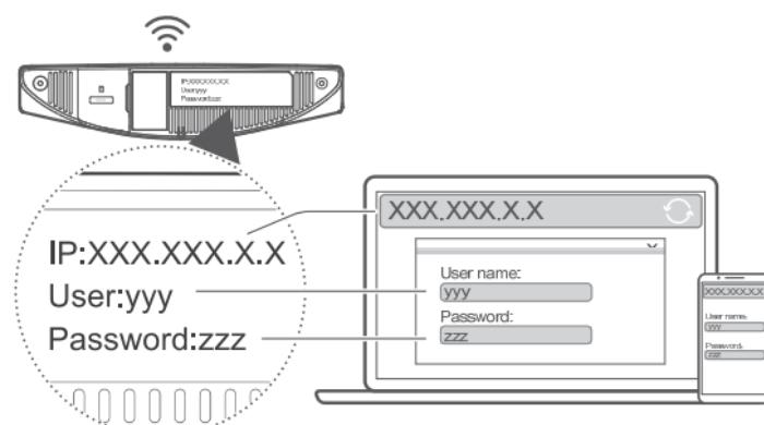
È possibile configurare il router utilizzando la pagina di gestione basata sul web. Fare riferimento all'etichetta in fondo al router per l'indirizzo IP, il nome utente e la password predefiniti.
