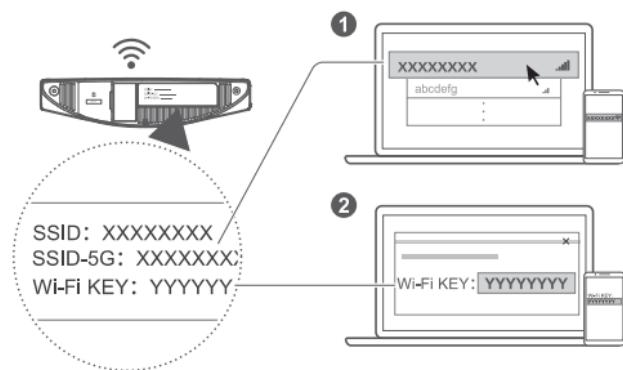
Una volta connesso il router alla rete di dati mobili è possibile connettere il computer o il telefono alla rete Wi-Fi del router per accedere a Internet. Fare riferimento all'etichetta in fondo al router per il nome della rete wireless (**SSID**) e la password (**Wi-Fi KEY**) predefiniti.
