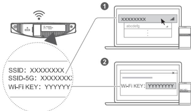
Una vez que el router se haya conectado a una red de datos móviles, se podrá conectar el ordenador o el teléfono móvil a la red Wi-Fi del router para acceder a Internet. Lea la etiqueta que se encuentra en la base del router para conocer el nombre (**SSID**) y la contraseña (**Wi-Fi KEY**) predeterminados de la red inalámbrica.
