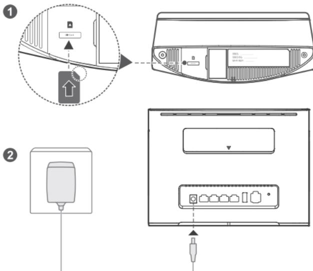
Plaats een micro-SIM-kaart in de micro-SIM-kaartsleuf zoals afgebeeld in het voorafgaande diagram en sluit de voedingsadapter aan op B525-router. De router zal automatisch worden ingeschakeld en zoeken naar beschikbare mobiele netwerken.
