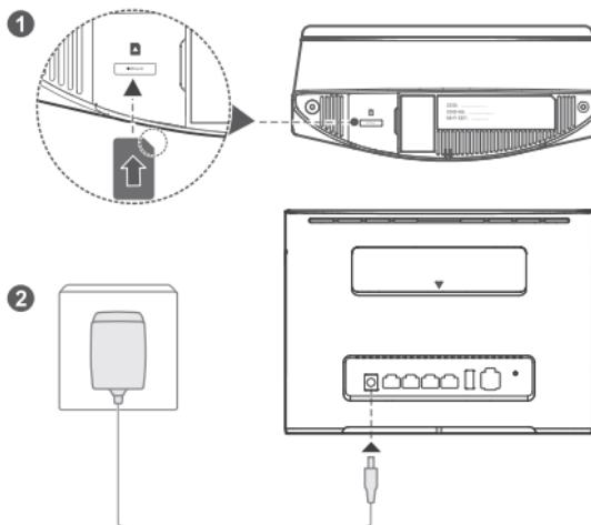
Introduza um cartão micro-SIM na ranhura para cartão micro-SIM, tal como apresentado no esquema anterior, e ligue o transformador ao router B525. O router ligar-se-á automaticamente e procurará as redes móveis disponíveis.
