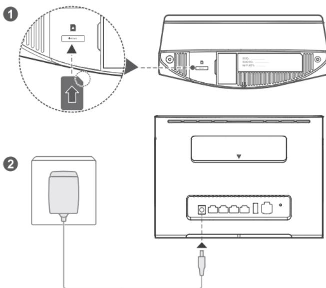
Insérez une carte micro-SIM dans l'emplacement correspondant, comme illustré sur le diagramme précédent, puis branchez l'adaptateur d'alimentation au routeur B525. Le routeur s'allumera automatiquement et chertera les réseaux mobiles disponibles.
