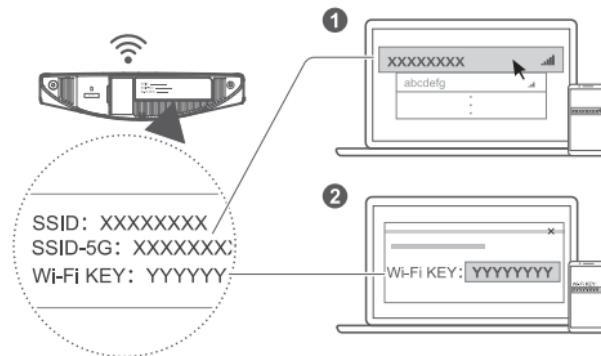
Depois de o router estar ligado a uma rede de dados móveis, pode ligar o computador ou telemóvel à rede Wi-Fi do router para aceder à Internet. Consulte a etiqueta na parte inferior do router para saber qual o nome da rede sem fios (**SSID**) e a palavra-passe (**Wi-Fi KEY**) predefinidos.
