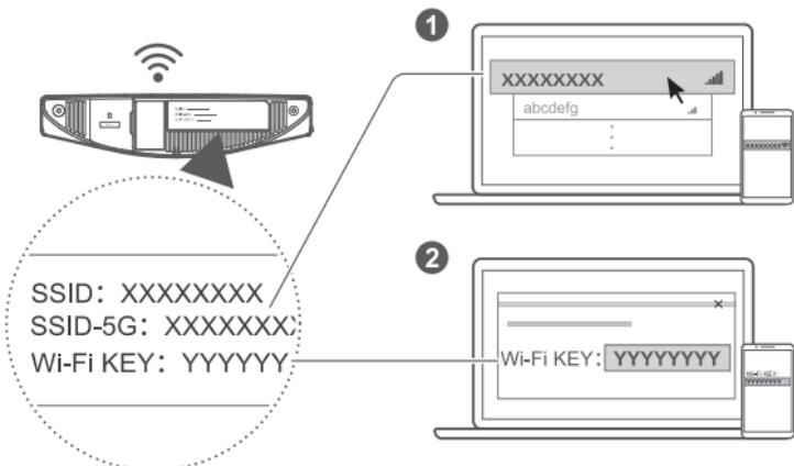
Zodra de router verbonden is met een mobiel datanetwerk kunt u uw computer of mobiele telefoon verbinden met het Wi-Fi-netwerk van de router voor toegang tot het internet. Op het label aan de
