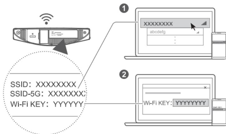
Sobald der Router eine Verbindung zu einem mobilen Netzwerk hergestellt hat, können Sie Ihre Computer oder Ihr Mobiltelefon mit dem WLAN-Netzwerk des Routers verbinden, um darüber auf das Internet zuzugreifen. Den standardmäßigen Namen des Drahtlosnetzwerks (**SSID**) und das Kennwort (**Wi-Fi KEY**) finden Sie auf dem Aufkleber an der Unterseite des Routers.
