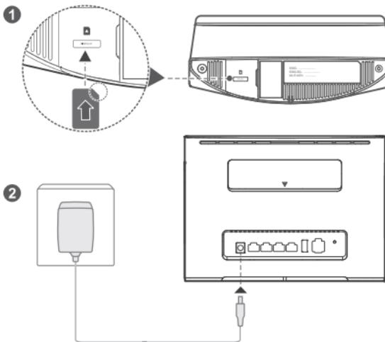
Setzen Sie die micro-SIM-Karte in den micro-SIM-Kartensteckplatz ein, wie in der vorstehenden Abbildung gezeigt, und schließen Sie den Netzadapter am B525-Router an. Der Router schaltet sich automatisch ein und sucht nach verfügbaren mobilen Netzwerken.
